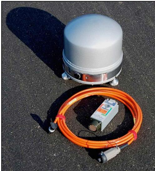
Fig. 4): Seismometer STS2.5
