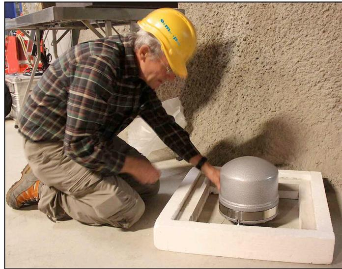
Fig. 5): Installation of the seismometer STS2.5
